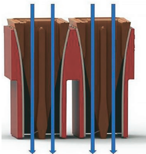
Rys. 2. Dwa modułowe elementy kanalikowe (ang. reed) umożliwiają przepływ gazu po liniach prostych.
