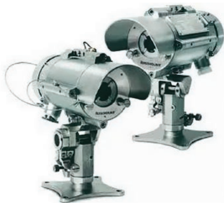
Fot. 2: Detektor gazów palnych z otwartą ścieżką Rosemount™ 935 firmy Emerson reaguje na tłumienie światła o określonych długościach fal, spowodowane przez obecność gazu wykrywalnego przez ten detektor. Chmura gazu pomiędzy źródłem światła a odbiornikiem wywołuje reakcję detektora. Źródło: Emerson
