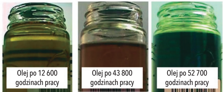
Fot. 5. Kolor syntetycznego oleju przekładniowego stosowanego w turbinie wiatrowej z czasem staje się coraz ciemniejszy.
