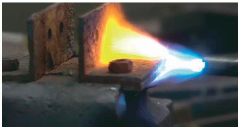
Fot. 1. Popularną metodą wykręcania zablokowanych śrub jest ich podgrzewanie do wysokiej temperatury, jednak proces ten stwarza wiele zagrożeń i wymaga dużych umiejętności. Źródło: Kano Laboratories.
