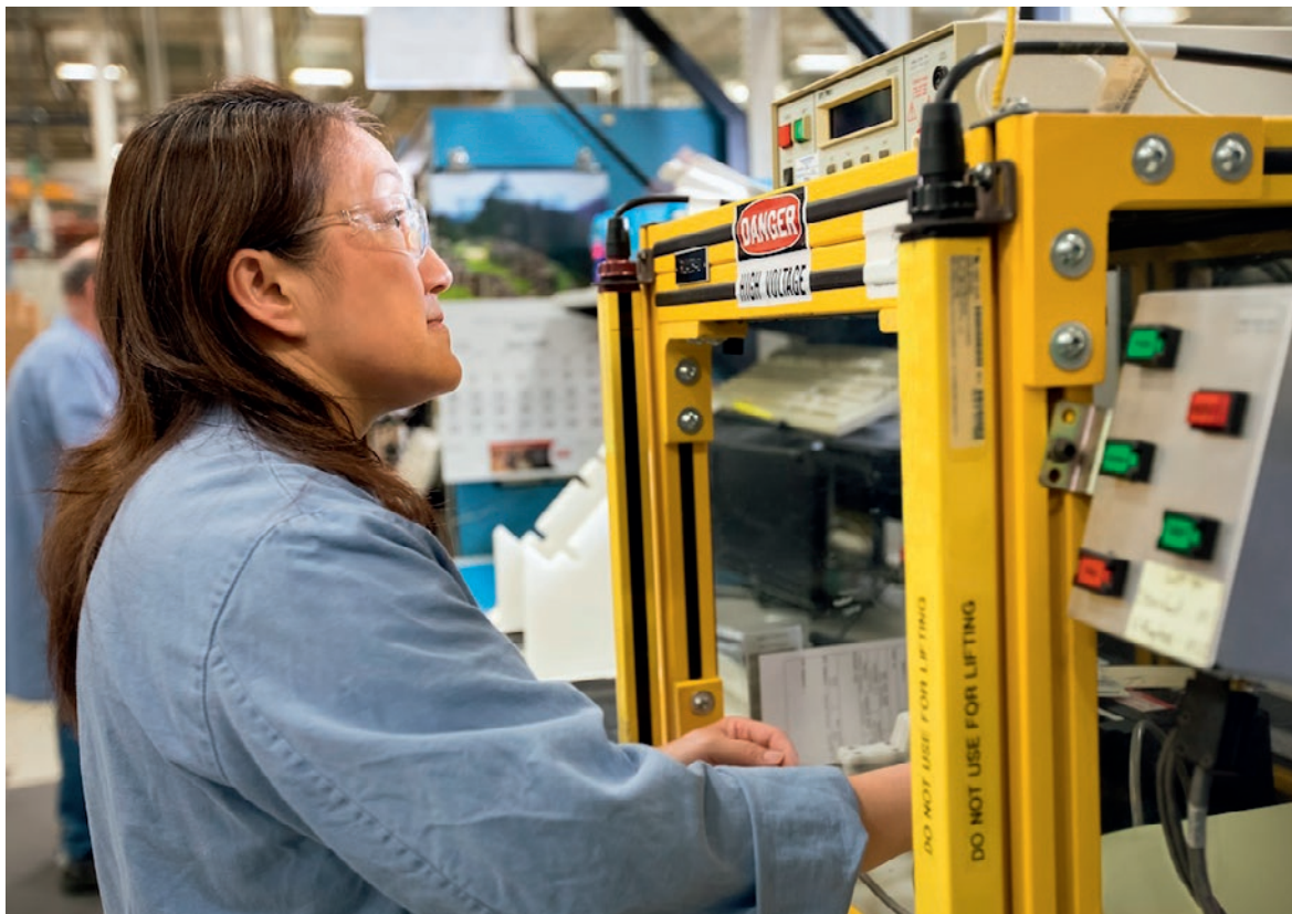
Ilustracja 3: Elektryczny test wysokiego napięcia PanelView podczas procesu regeneracji. Dzięki uprzejmości: Rockwell Automation
