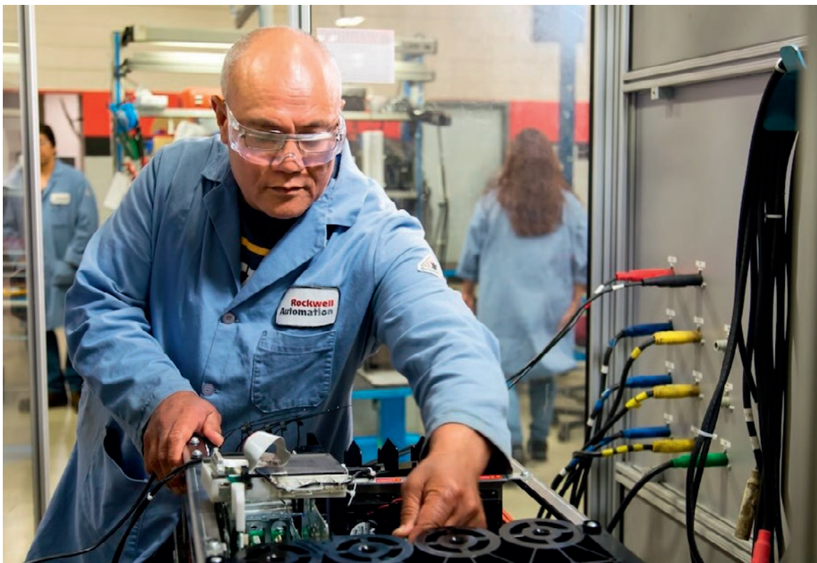
Ilustracja 2: Zautomatyzowane testowanie podczas procesu regeneracji. Dzięki uprzejmości: Rockwell Automation
