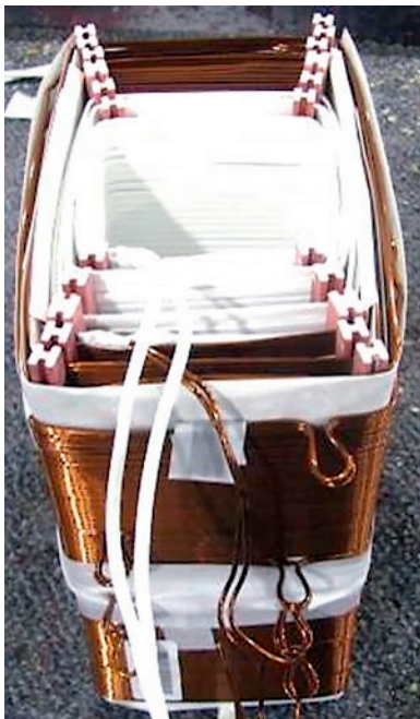
Rysunek 5: Konstrukcja jednej cewki transformatora w której widać kanały chłodzące. Dzięki uprzejmości: ABB
