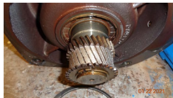
Ilustracja 7: Awaria zębnika spowodowana niskim poziomem oleju. Dzięki uprzejmości: Upper Occoquan Service Authority
