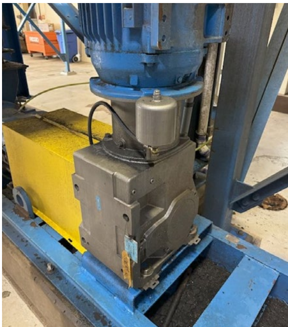
Ilustracja 5: Napęd zębaty progresywnej pompy wnekowej. Dzięki uprzejmości: Upper Occoquan Service Authority
