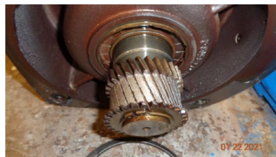
Ilustracja 7: Awaria zębata spowodowana niskim poziomem oleju. Dzięki uprzejmości: Upper Occoquan Service Authority
